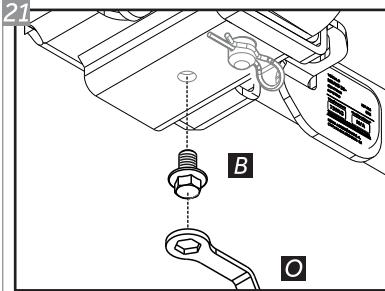
Após posicionar a Ponteira, localize o furo para inserir o Parafuso Anti Ruído, item "B". Aperte o mesmo para evitar que a trepidação do veículo, em terrenos irregulares, gere ruídos indesejados.
