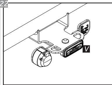
Observe que, quando o engate não for utilizado, a Ponteira deve ser substituída pela Tampa de Proteção "V". Após colocada, a tampa de proteção deverá ser fixada com o Pino Travão "P" e com o Grampo "Q" afim de evitar a perda da mesma.
