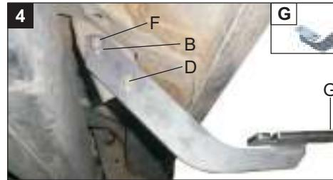
Mittlere Stütze "G" anbringen, Unterlegscheibe "B", Schrauben "D", Gewindemutter "F" benutzen, sowie die Schrauben und Gewindemuttern des Vehikels. Aufpassen, dass die Falze der Stütze "G" in Richtung Vorderseite des Vehikels zeigt.
