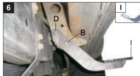
Die mittlere Stütze "I" mithilfe der Schrauben "D", den Unterlegscheiben "B" und den Gewindemuttern, die schon im Vehikel sind, anbringen. Dabei aufpassen, dass die Falze der Stütze in Richtung Zentrum des Fahrzeugs zeigt.
