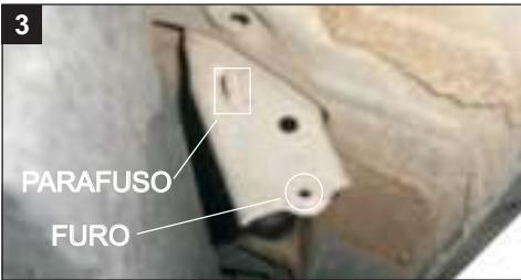
**Mittlere Stütze:** Die Mittlere Stütze "G" sollte auf einem schon existierenden Schild des Fahrzeugs angebracht werden, wie auf der Abbildung. Das Anfügen erfolgt mithilfe der bereits existierenden Schrauben und Löcher. Neben dem Loch, befindet sich auch eine Schraubemutter, die benutzt werden sollte.
