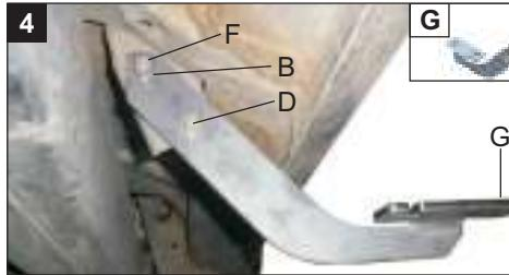
Fixar o suporte central "G" utilizando arruelas "B", parafuso "D", porca "F", parafuso e porca já existentes. Observar para que a dobra do suporte "G" fique voltada para a frente do veículo.
