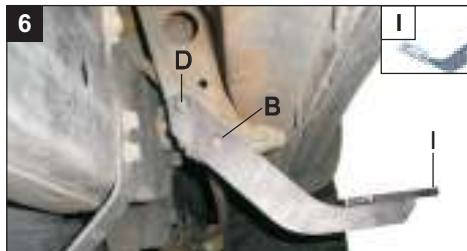
Fixar o suporte traseiro "I", utilizando parafusos "D", arruelas "B", e porcas já existentes no veículo. Observar para que a dobra do suporte "I" fique voltada para a traseira do veículo.
