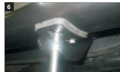
Das Gestell "G" an der Frontseite des Vehikels anbringen, so dass eine der ovalen Öffnungen in die Schrauben passt, die sich im Gehäuse des Vehikels befinden.
