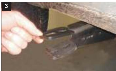
Colocar os acabamentos plásticos nos encaixes dos suportes.
